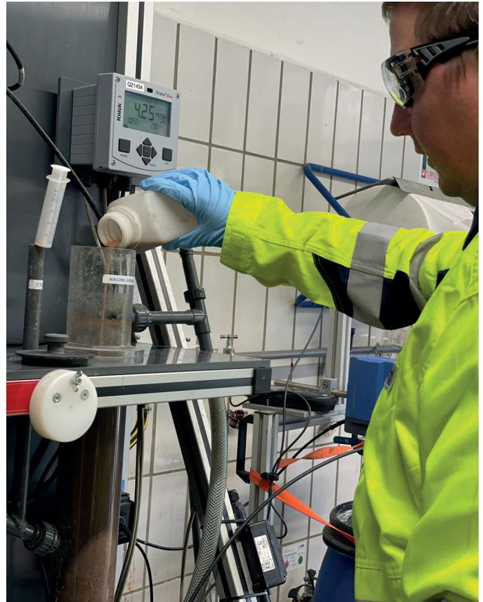
Mikroorganismen werden in die Anlage gefüllt. So soll eine Mini-Kläranlage
