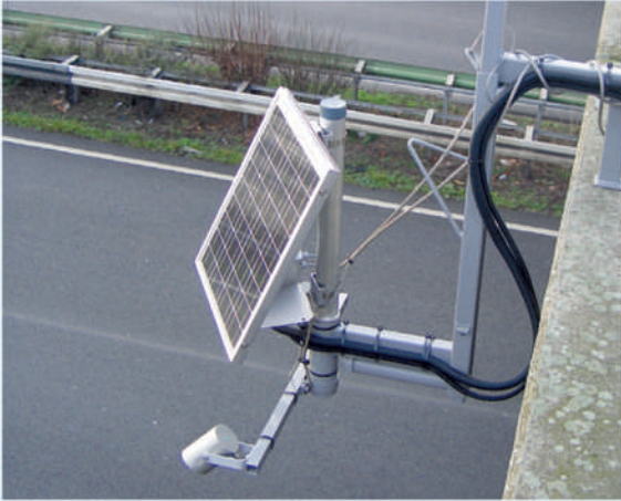
→ Ein Traffic Eye an der so genannten Eisenbahnbrücke über die B 44: Diese solarbetriebenen Verkehrs-Augen erfassen die Verkehrsdaten, also die Anzahl der Fahrzeuge, deren Geschwindigkeit und die Fahrzeugklassen. Daraus kann die Verkehrsdichte errechnet werden.
