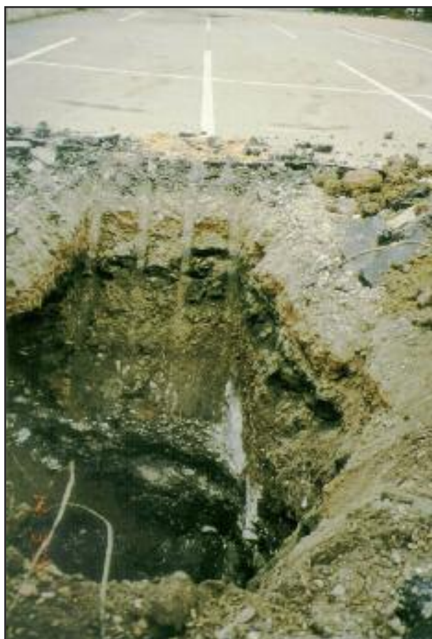
Schurf mit erkennbarer weißer HCH-Ablagerung
