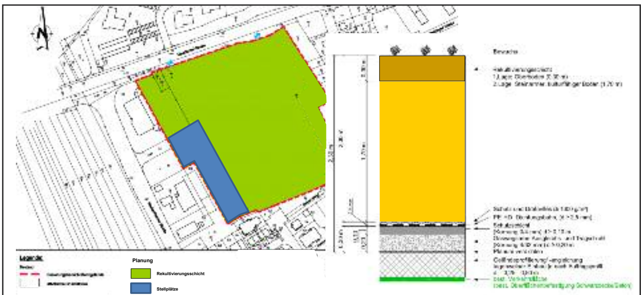
Vorzugsvariante: Oberflächenabdichtung mit Reklamierungsschicht und Stellplätzen
