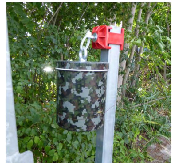
Umgebungsüberwachung Radon (Foto: SGD Süd)
