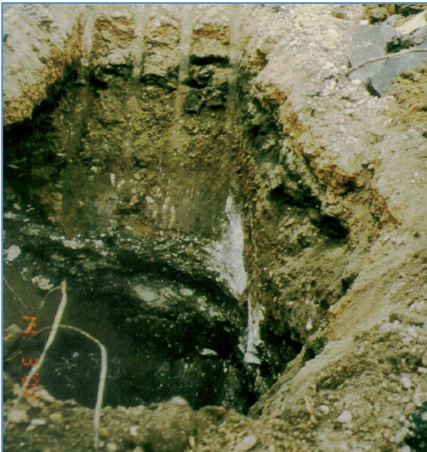
Schurf mit erkennbarer weißer HCH-Ablagerung
