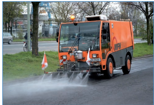
Feuchtkehren der Fahrbahn vermeidet das Aufwirbeln von Staub
