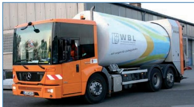
Modernes Drehtrommelfahrzeug des WBL
