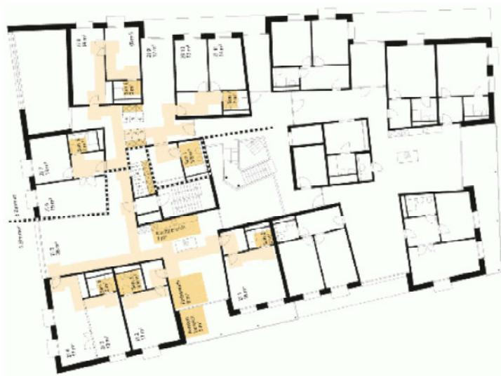
Abbildung 1 Grundriss Satellitenwohnung Quelle: <https://www.wbs.admin.ch/de/anwendung/glossar/cluster-und-satellitenwohnungen>
