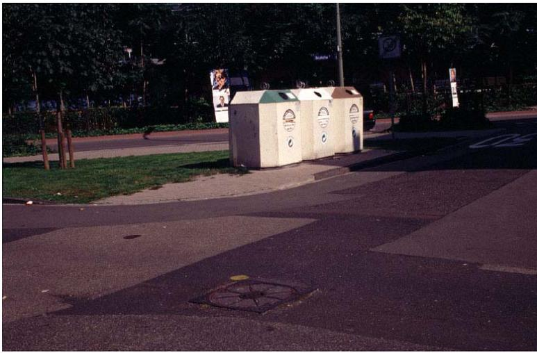
*Dieses Beispiel unterscheidet sich vom vorherigen dadurch, dass zumindest die Verkehrsinsel, auf der die Müllcontainer stehen, barrierefrei zugänglich ist. Dennoch entspricht auch diese Lösung nicht den Kriterien der Barrierefreiheit, da die Mülltonnen nicht tiefergelegt sind und somit von Rollstuhlbenutzern nicht befüllt werden können. Geländedreieck Margarethen-, Gudrun-, Deutsche Straße.*
